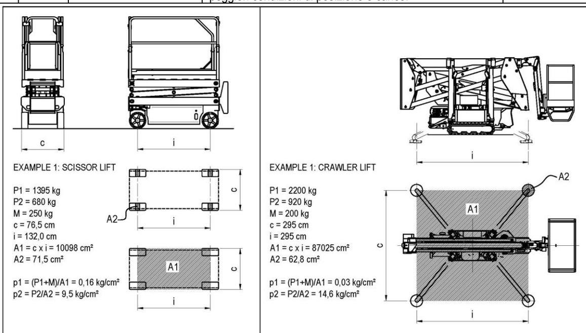
Di seguito riportiamo una tabella indicativa della portanza del suolo suddivisa per tipologia di terreno. Riferirsi ai dati contenuti nelle tabelle specifiche di ogni modello (capitolo 2, CARATTERISTICHE TECNICHE MACCHINE STANDARD) per ricavare il dato relativo alla massima pressione al suolo provocata dalla singola ruota.
