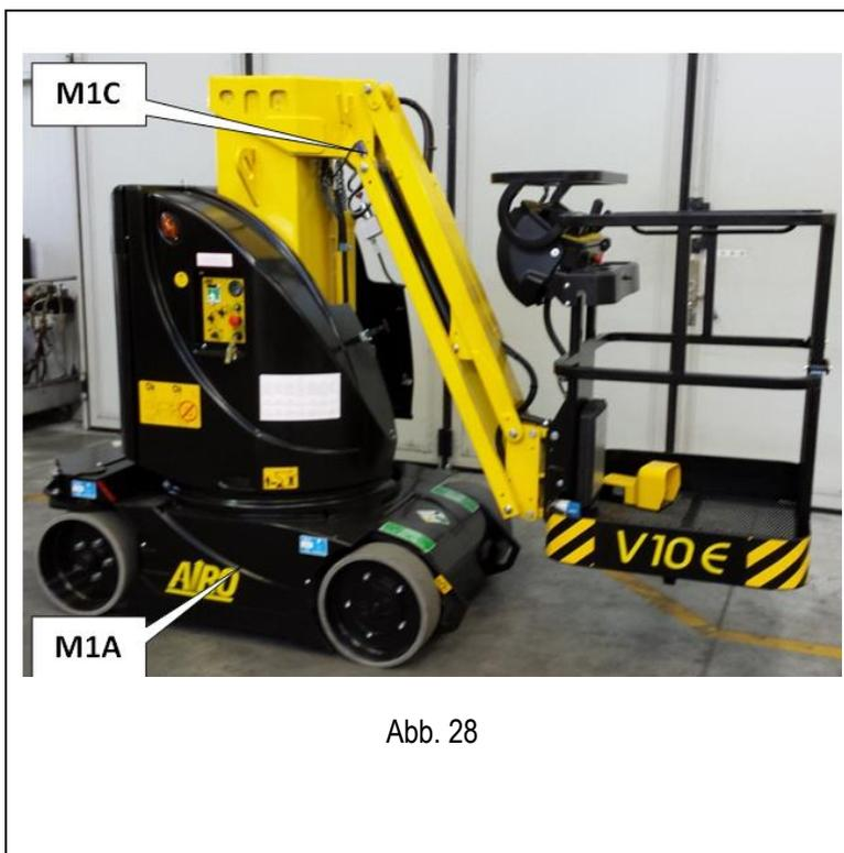
Die Funktionen des Mikroschalters M1C am Korbarm wurden konzipiert, um die Auf-/Abladung auf die/von den Rampen eines Fahrzeugs zu erleichtern und sind folgende:
