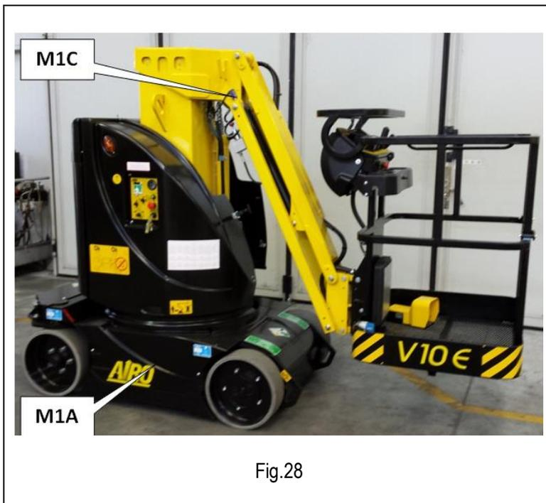
Le funzioni del microinterruttore M1C sul Jib sono state studiate per favorire le operazioni di carico/scarico dalle rampe di un automezzo e sono le seguenti:
