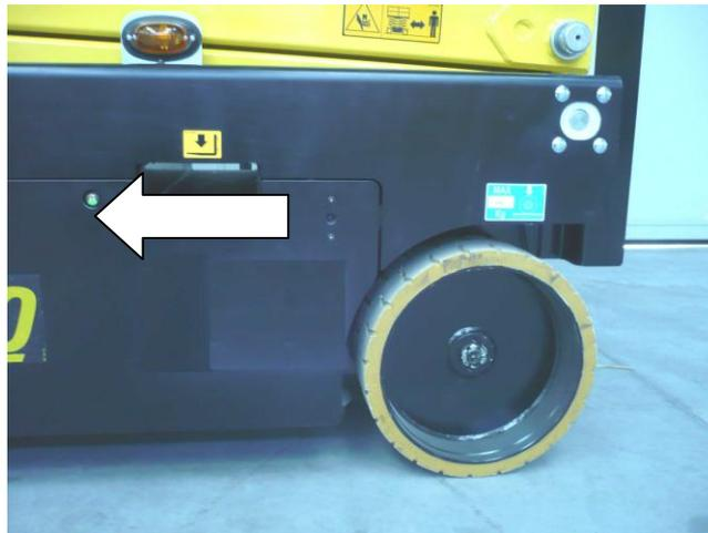
7-14: Luz testigo cargador de baterías
