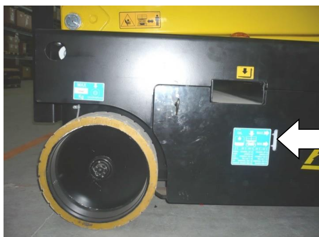
7-6: Hladina oleje- otvor pro hadici Série X
