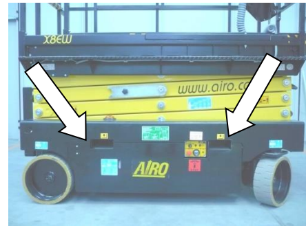
6-2: otvory pro vidlici vysokozdvízného vozíku
