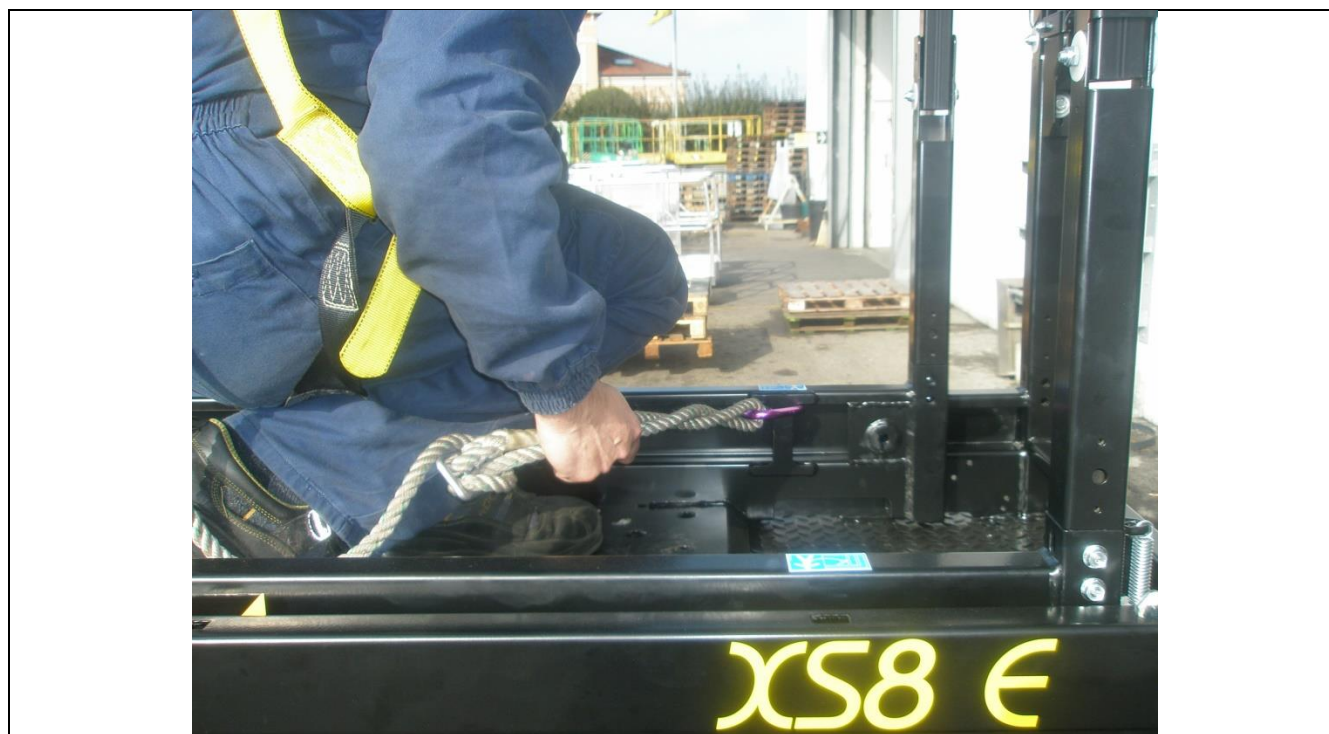
3-1: kotevní body pro bezpečnostní postroje
