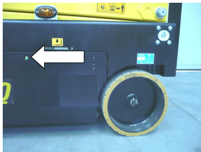
7-1510: 蓄电池充电器指示灯
