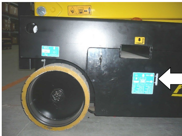
7-6: Ventanilla de inspección del nivel de aceite serie X
