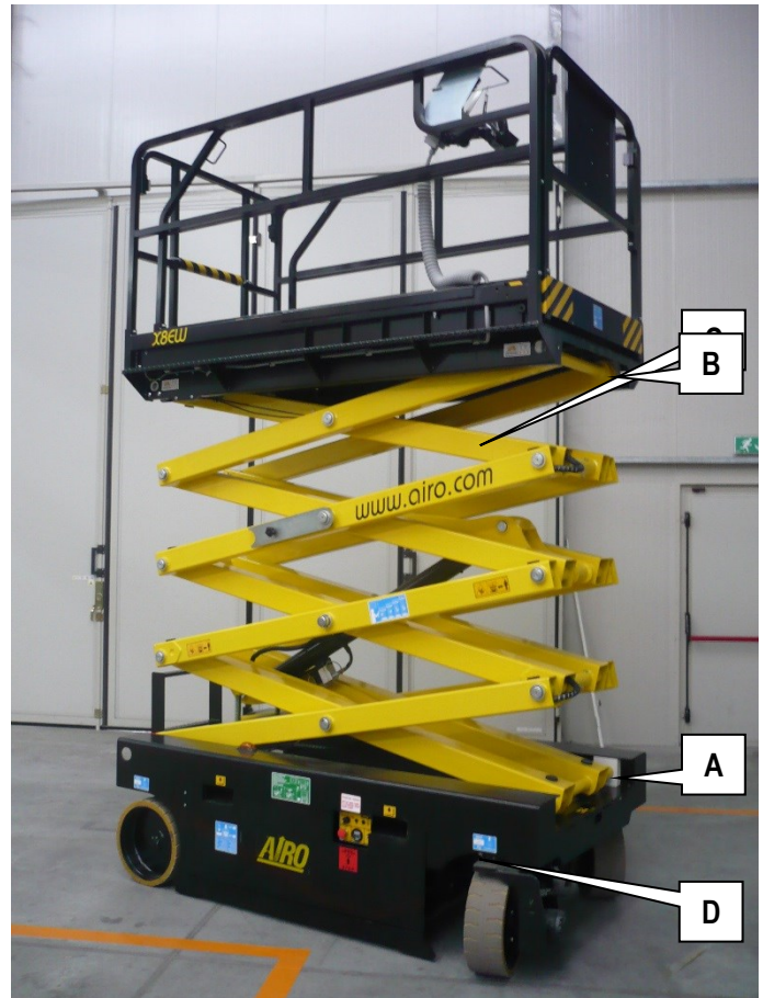
7-5: Ubicación de las partes principales a engrasar
