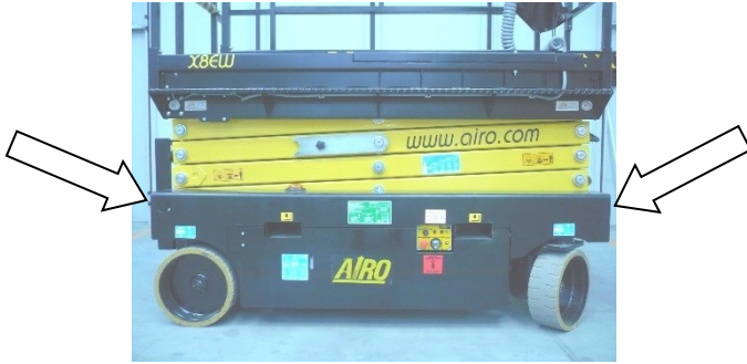
6-1: Orificios de anclaje
