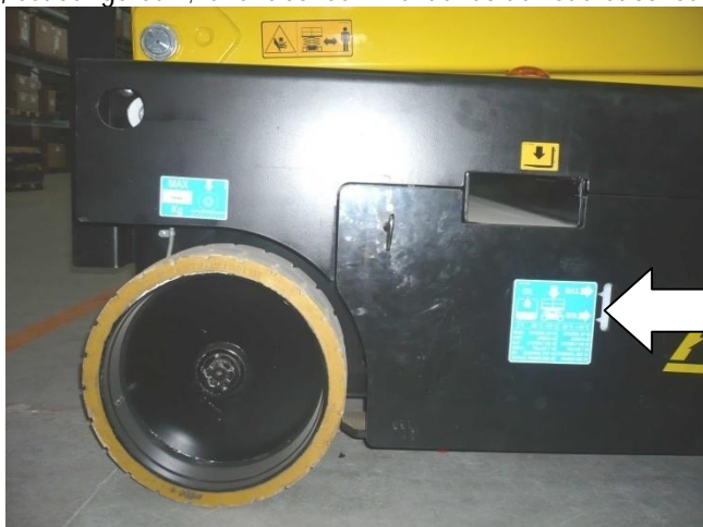
7-6: Verre-regard pour contrôler le niveau de l'huile série X
