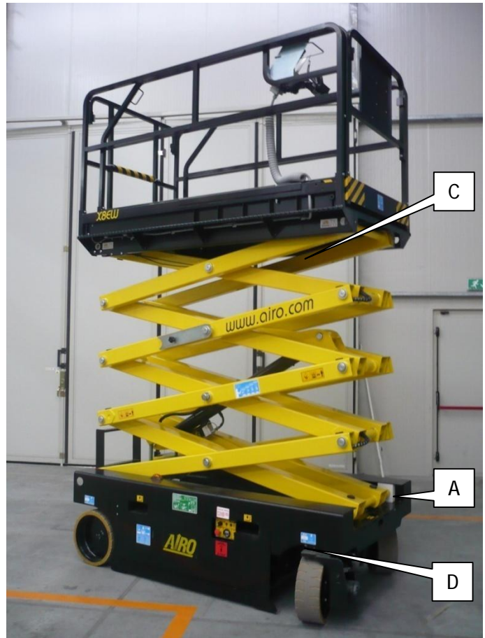
7-5: Principaux emplacements des parties à graisser
