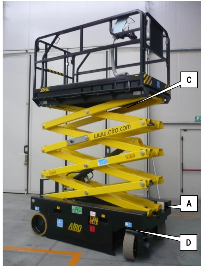
7-5: Principaux emplacements des parties à graisser
