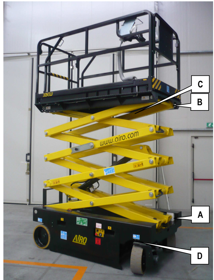
7-5: Principaux emplacements des parties à graisser
