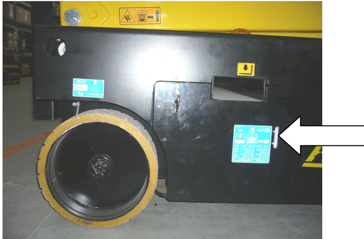
7-6: Verre-regard pour contrôler le niveau de l'huile série X
