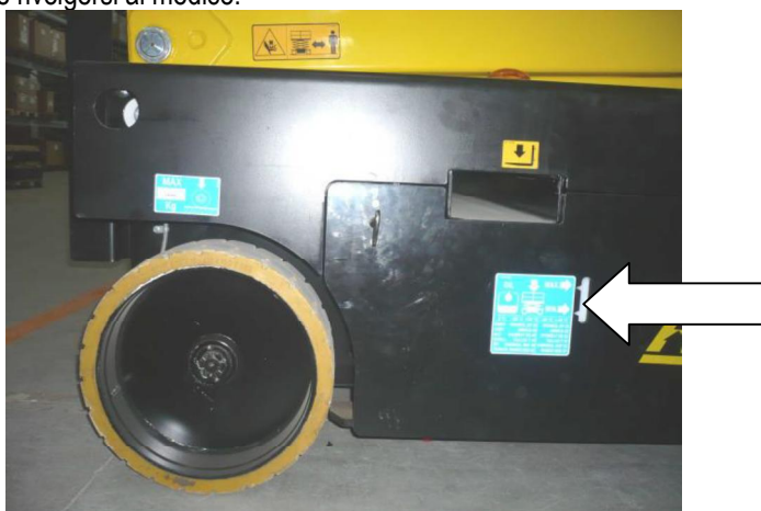
7-6: Finestrella ispezione livello olio serie X
