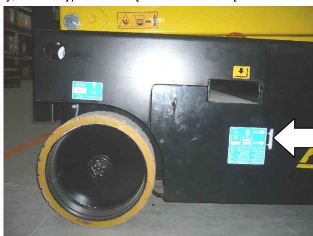
7-6: Wziernik poziomu oleju serii X
