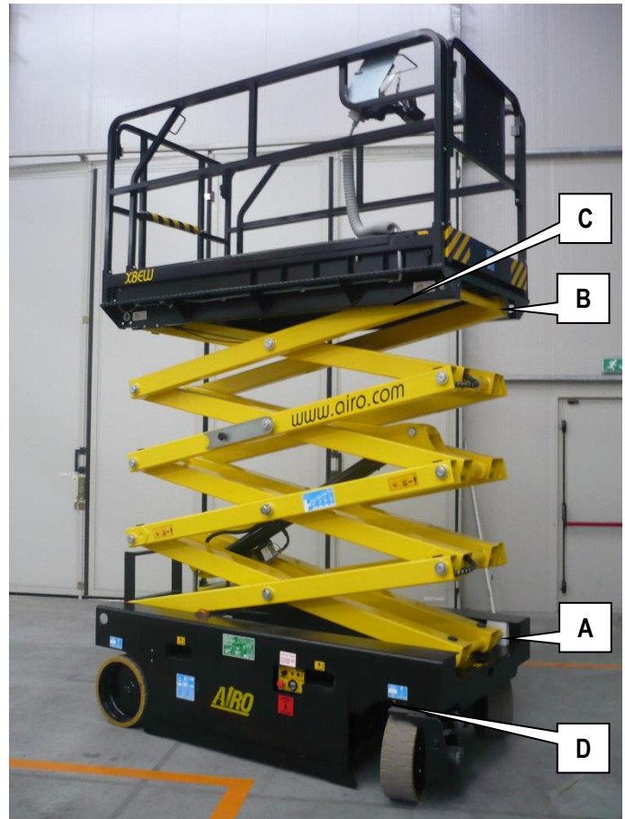
7-5: Rozmieszczenie głównych części do smarowania
