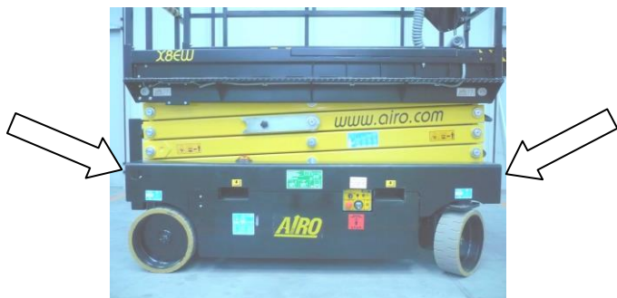
6-1: Furos de ancoragem
