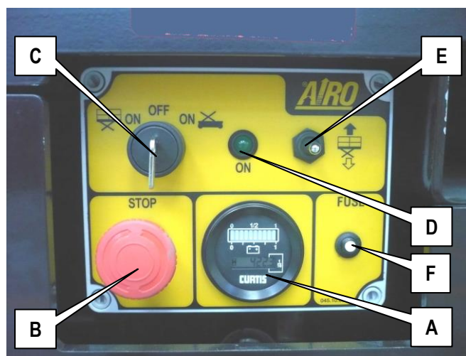
5-3: Quadro de comandos no chão
