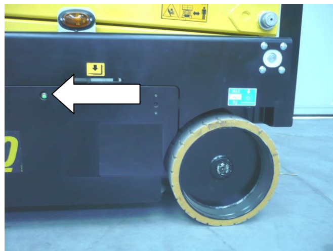
7-1510: Indicador luminoso do carregador
