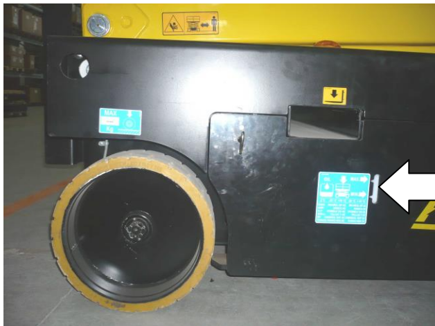
7-6: Visor de inspeção do nível de óleo, série X
