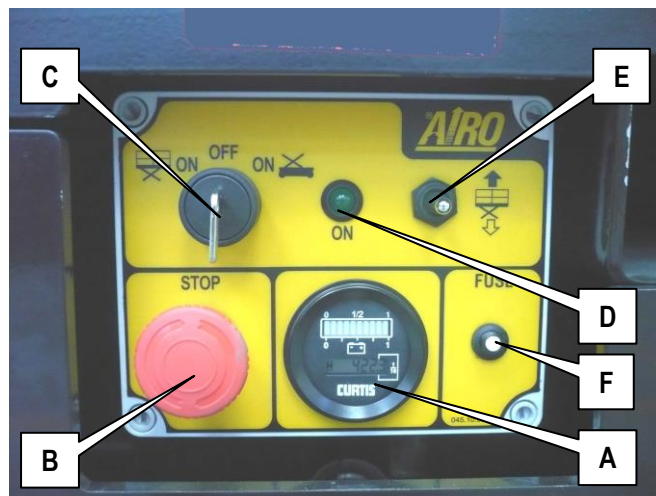
5-3: Panou de comenzi la sol
