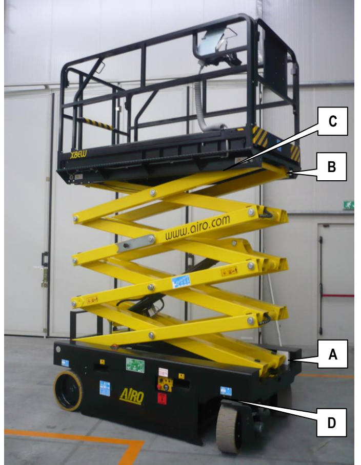
7-5: Yağlanacak ana parçaların yerleri
