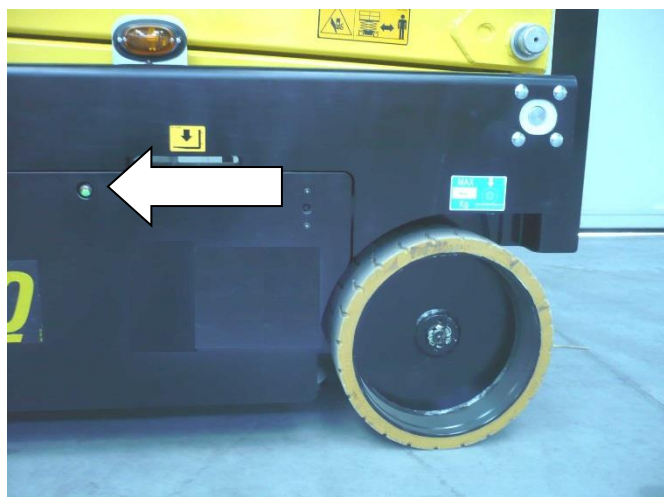
7-15: Kontrolka ładowarki akumulatora
